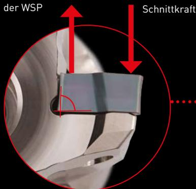
Die Schwalbenschwanzgeometrie der Anlagefläche verhindert zuverlässig ein Anheben der WSP und gewährleistet stabiles Einspannen auch ohne die Verwendung einer Spannpratze.
